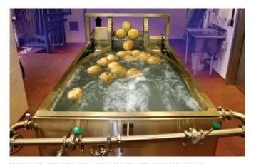
FIGURE 26.3 Surface pasteurization of cantaloupes.
